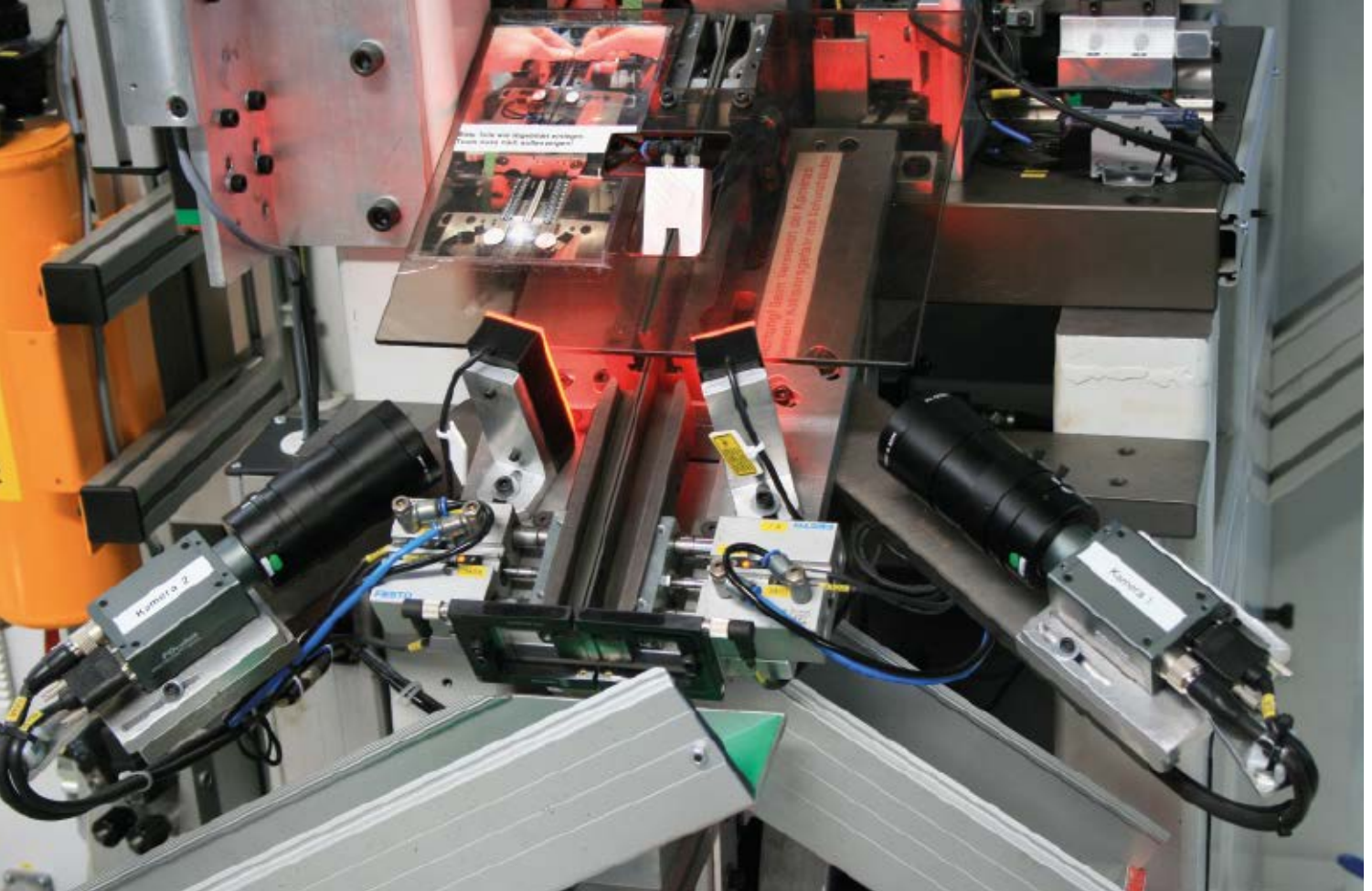
Praxisbeispiel: Bestehende PC-basierte Vision-Systeme können durch intelligente Kameras erweitert werden.
